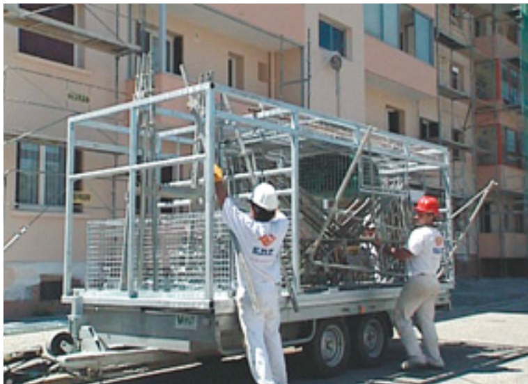
« Cage » spécifique de stockage de l'échafaudage posé sur sa remorque de transport.
