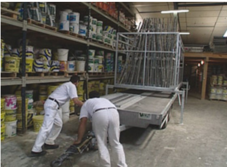
« Cage » de stockage sur ses béquilles et enlèvement de la remorque.
