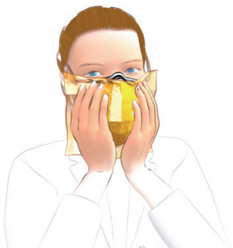
( Test d'étanchéité à pression négative
